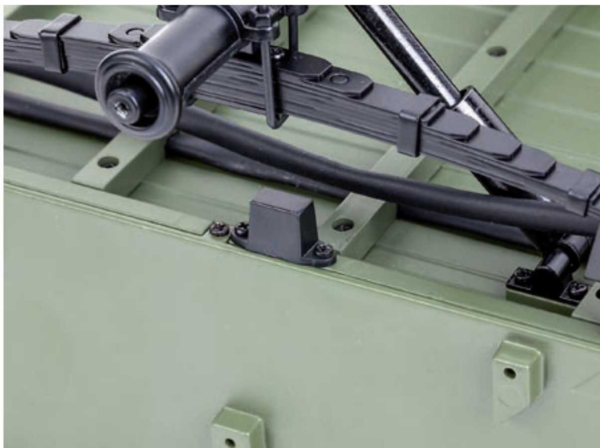
Шаг 4. Закрепите ранее снятый буфер рессоры на полу прицепа. Для фиксации детали используйте два винта 1,7×4 (СМ).
