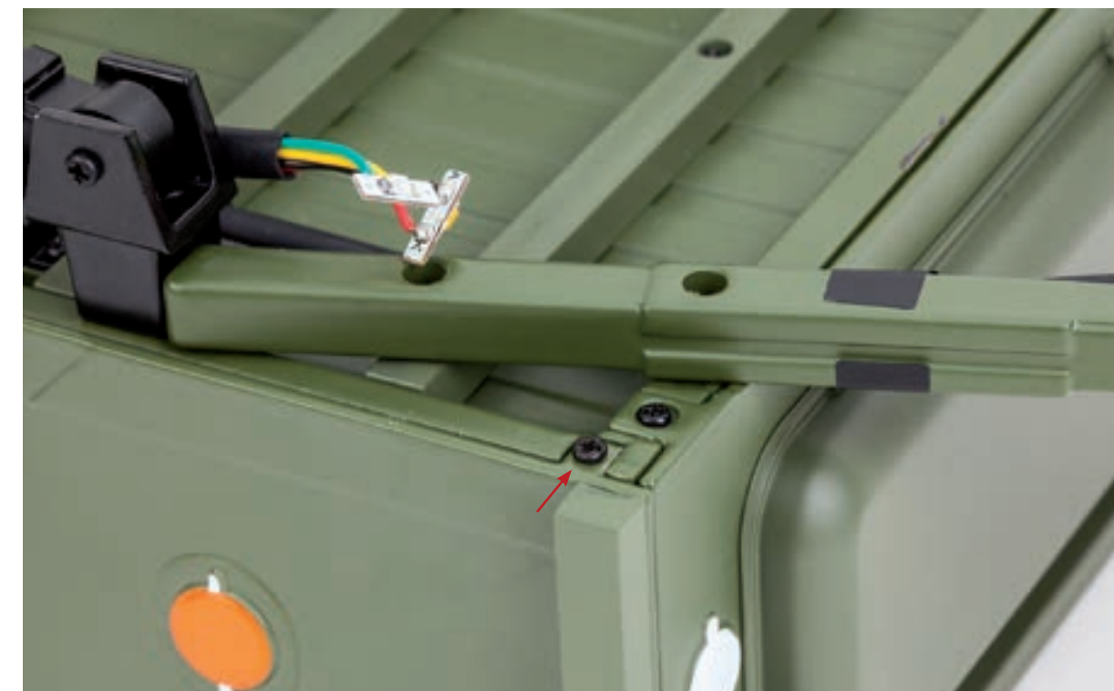
Шаг 3. Установите борт на пол кузова прицепа. Совместите крепежные отверстия в переднем, среднем и заднем кронштейнах борта с ответными отверстиями, расположенными на нижней плоскости пола кузова прицепа. Закрепите борт при помощи трех винтов 1,7×5 (DM).
