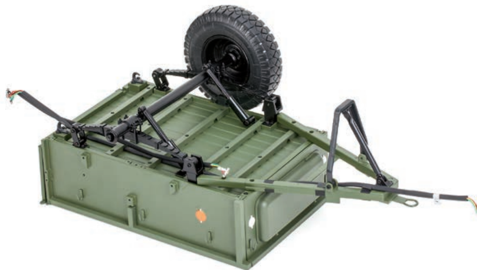
Шаг 3. Установите борт на пол кузова прицепа. Совместите крепежные отверстия в переднем, среднем и заднем кронштейнах борта с ответными отверстиями, расположенными на нижней плоскости пола кузова прицепа. Закрепите борт при помощи трех винтов 1,7×5 (DM).
