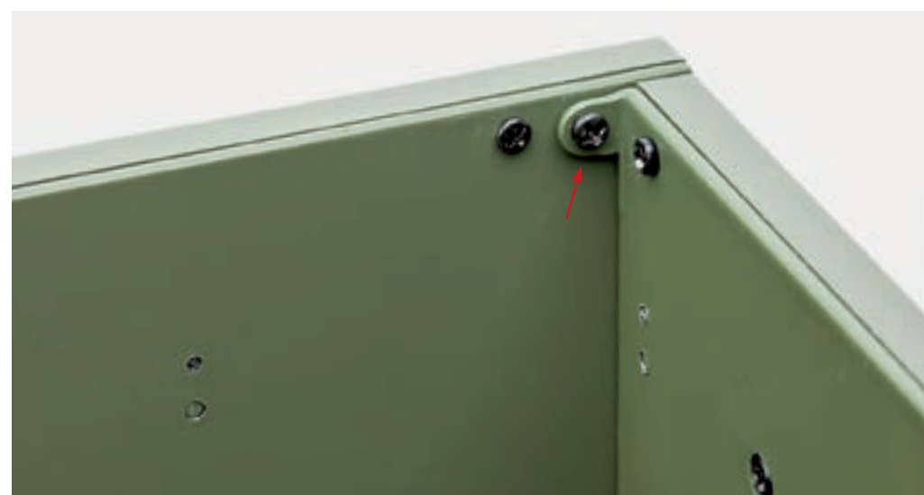
Шаг 5. Дополнительно, при помощи винта 1,7×5 (DM), зафиксируйте левый борт на кронштейне переднего борта прицепа с внутренней стороны.
